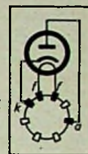
Sockelschaltung Anschlüsse von unten gesehen
