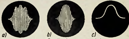
a) HF-Kurve eines überkritisch gekoppelten Bandfilters Bandbreite: breit
